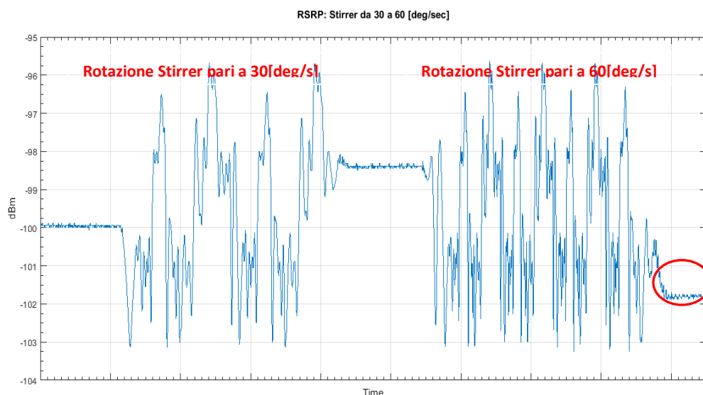
Figura 59: Andamento RSRP al variare della velocità di rotazione dello stirrer
