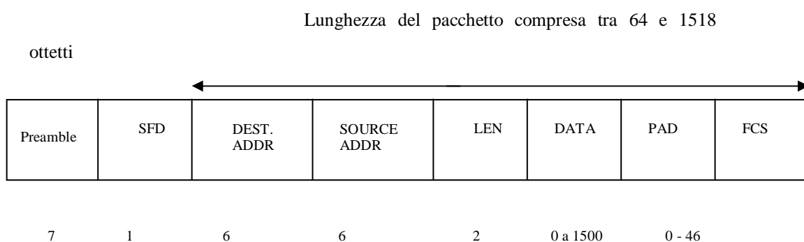
Fig. 1.4.1.3 Struttura del pacchetto per lo standard IEEE 802.3
