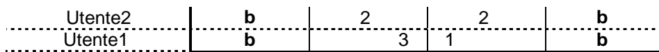
Figura 2.3 Le due parole di codice di fig. 2.2 sono ortogonali, con l'introduzione del carattere di blank b.
